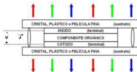
Figura 11. Estructura del OLED
