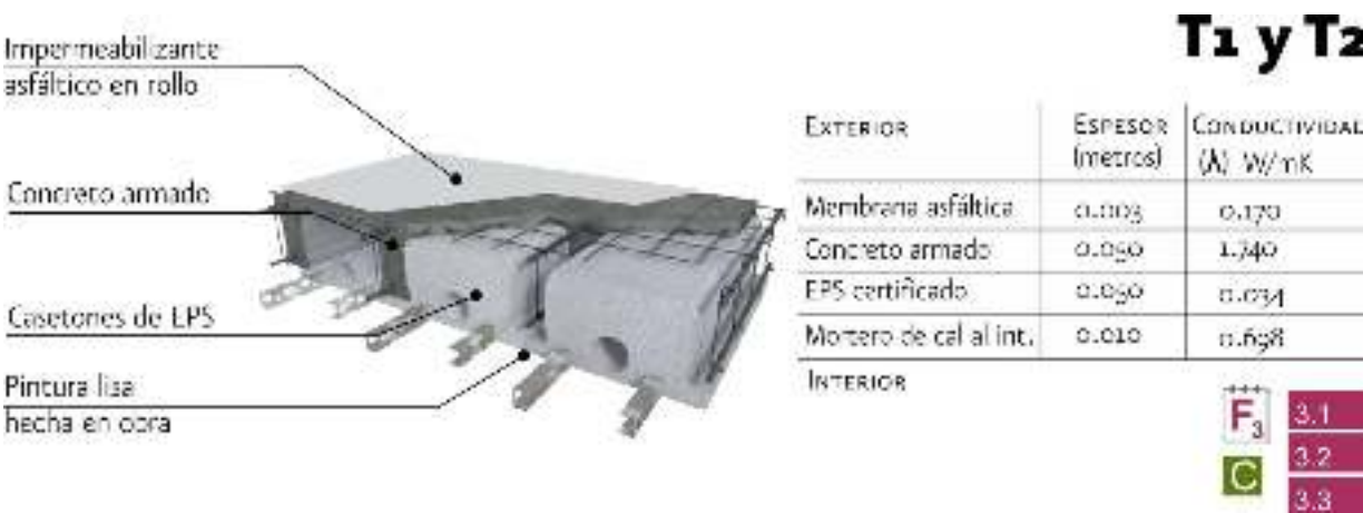
Fig. 6.7 Composición de las losas T1 y T2 de acuerdo a proyecto arquitectónico.
