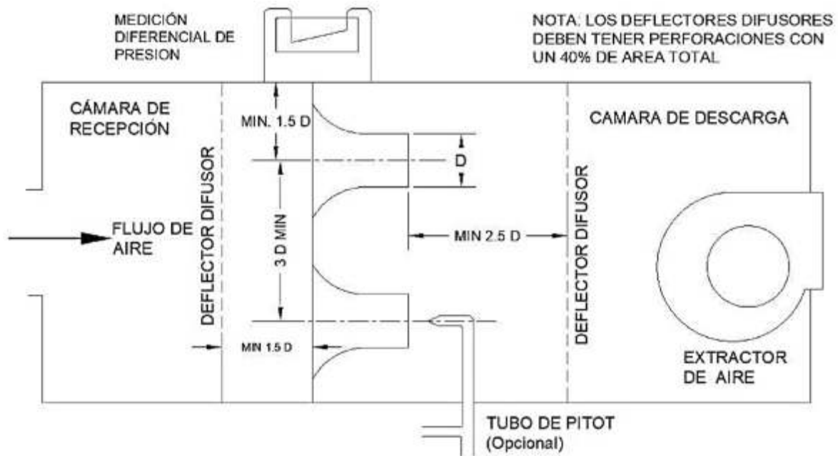
Figura A.1 - Aparato de medición de flujo de aire
