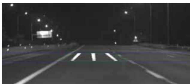
Figura 8. Ejemplo de medida de luminancia horizontal en el pavimento de un carril en carretera iluminada a cielo abierto y en túnel.
