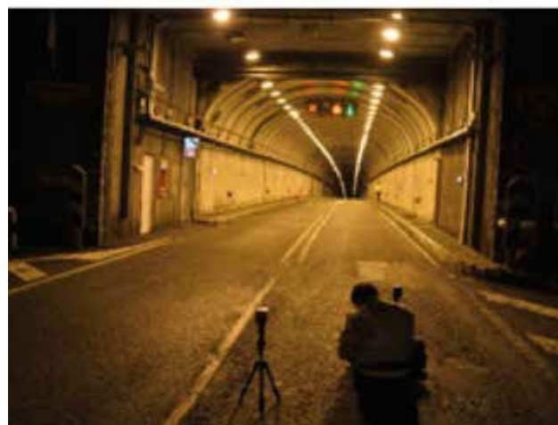
Figura 16. Ejemplo de medidas de luminancias puntuales con luminancímetros manuales.
