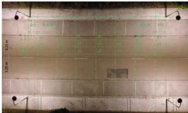
Figura 12. Puntos de medida de iluminancia según la normativa UNE-EN 13201-3:2016 para un carril de la calzada. Retícula simplificada según el método denominado de los “nueve puntos”.
