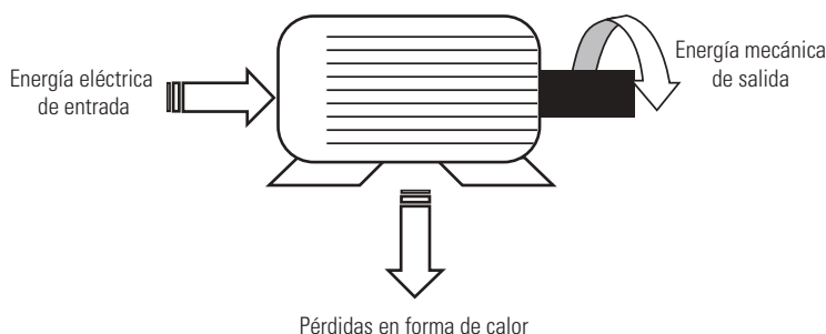
GRÁFICO 6.5 Flujo de energías en un motor eléctrico
