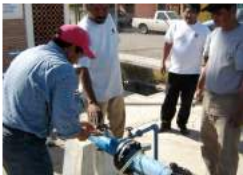
FOTOGRAFÍA 5.1 Medición de presión con manómetro tipo Bourdon calibrado
